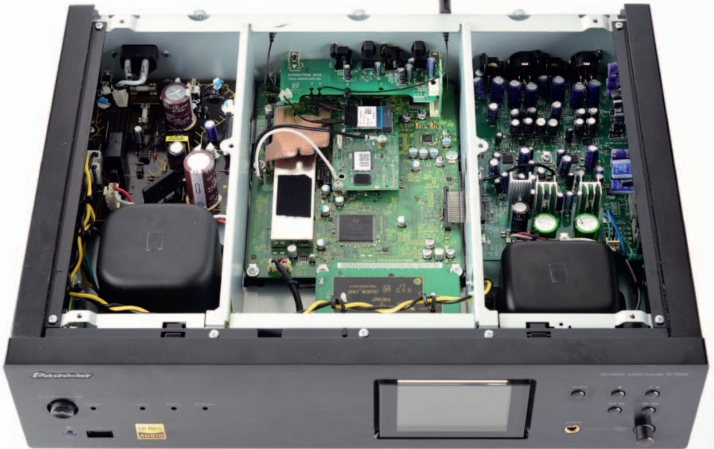
Strikte Gütertrennung im N-70AE: Die Netzteile und Transformatoren für den analogen und den digitalen Bereich liegen weit auseinander. Als wäre das nicht genug, kommen auch noch abschirmende Trennwände zum Einsatz. Die einzelnen Kammern sind ziemlich dicht beieinander. Eine stabile Bodenplatte sorgt zusätzlich für mechanische Stabilität.
