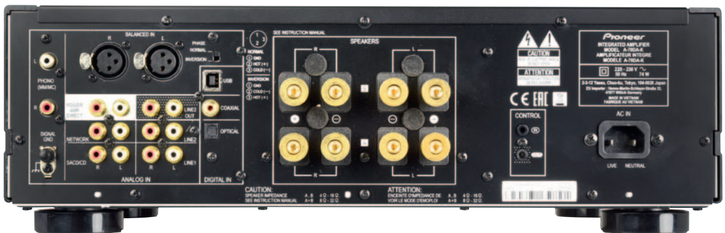
Ein prall geschnürtes Paket: Der Pioneer bietet Schnittstellen in Hülle und Fülle. Von Phono (MM + MC) über vier analoge bis hin zu drei digitalen Eingängen. Diese treten beim Pioneer-Duo aus Amp und Streamer doppelt auf. Dazu noch symmetrische und asymmetrische Ausgänge sowie ein Endstufenausgang. Die Phase des symmetrischen Eingangs lässt sich umschalten.
